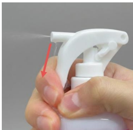
下方向の亀裂の場合：液だれ
